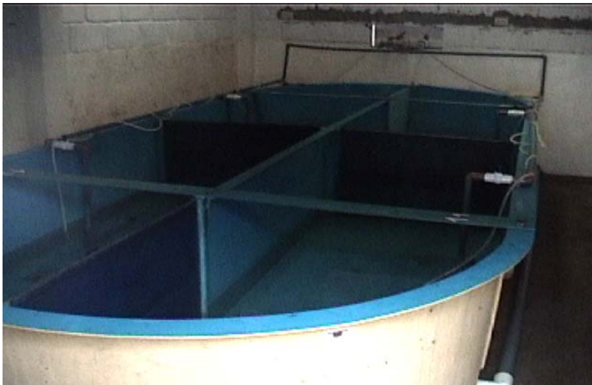
Figura 5. Tanque con 4 compartimientos independientes utilizado para evaluación de la tasa de ingestión y tiempo de respuesta a la presencia de los atractantes por parte de los reproductores de Litopenaeus vannamei .
