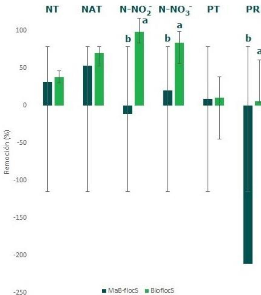
**Fig. 5. Remoción de especies de nitrógeno y fósforo en los reactores MaB-flocS y el BioflocS para el tratamiento de los influentes superficiales de un cultivo intensivo de camarón blanco del Pacífico**
