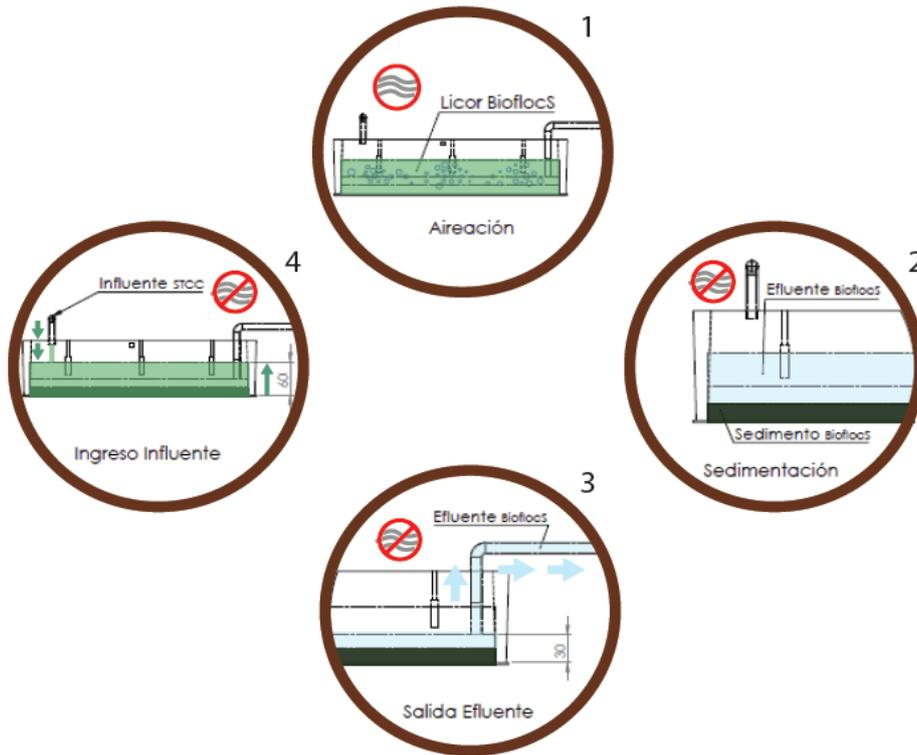
Fig. 3. Funcionamiento del reactor BioflocS para el tratamiento del sobrenadante del cultivo intensivo de camarón blanco del Pacífico. 1) Aireación del contenido del reactor ( $Licor_{BioflocS}$ ). 2) La aireación se detiene y se forman dos fases ( $Effluente_{BioflocS}$  y el sedimento). 3) Descarga del sobrenadante ( $Effluente_{BioflocS}$ ). 4) Ingreso del agua del sobrenadante del cultivo intensivo de camarón al reactor BioflocS y se reactiva la aireación.
