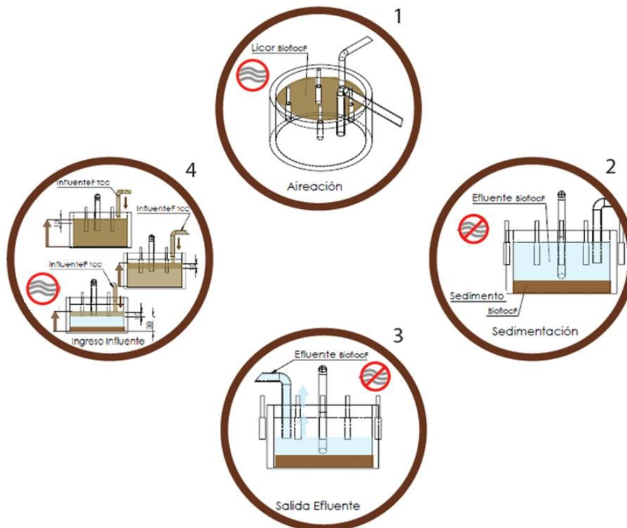
Fig. 4. Funcionamiento del reactor BioflocF para el tratamiento del agua del fondo del cultivo intensivo de camarón blanco del Pacífico. 1) Aireación del contenido del reactor ( $Licor_{BioflocF}$ ). 2) La aireación se detiene y se forman dos fases ( $Effluente_{BioflocF}$
