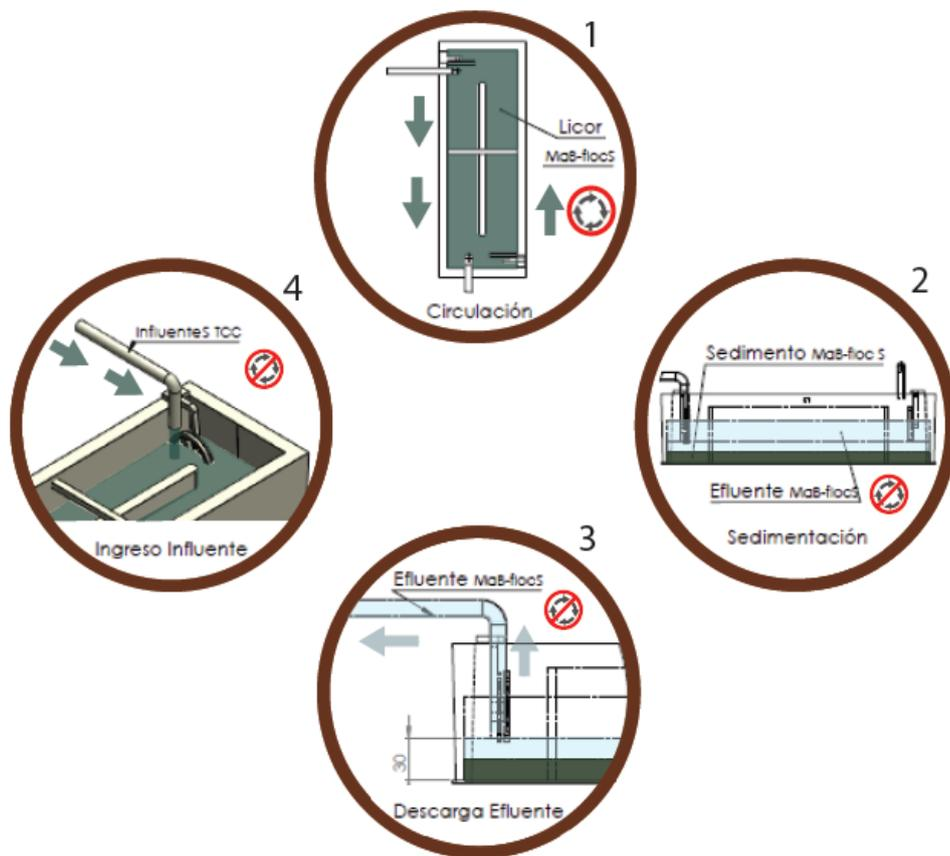
**Fig. 2.** Funcionamiento del reactor MaB-flocS para el tratamiento del sobrenadante del cultivo intensivo de camarón blanco del Pacífico. 1) Circulación del contenido del reactor (Licor<sub>MaB-flocS</sub>). 2) La circulación se detiene y se forman dos fases (Efluente<sub>MaB-flocS</sub> y el sedimento). 3) Descarga del sobrenadante (Efluente<sub>MaB-flocS</sub>). 4) Ingreso del agua del sobrenadante del cultivo intensivo de camarón al reactor MaB-flocS y se reactiva la circulación.
