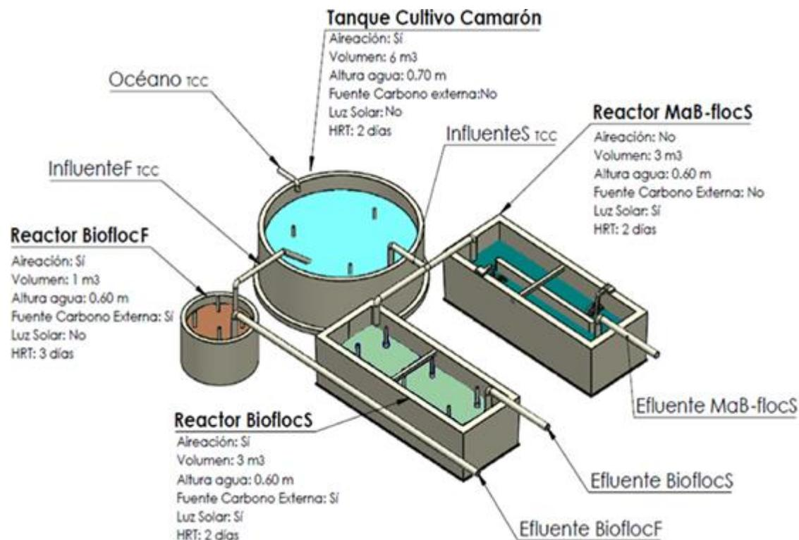
**Fig. 1. Sistema de tratamiento de aguas residuales de un tanque de cultivo intensivo de camarón blanco del Pacífico. El sobrenadante del cultivo de camarón (Influente<sub>S</sub>TCC) es tratado mediante los reactores MaB-flocS y BioflocS. El efluente del fondo del tanque (Influente<sub>F</sub>TCC) es tratado mediante el reactor BioflocF.**
