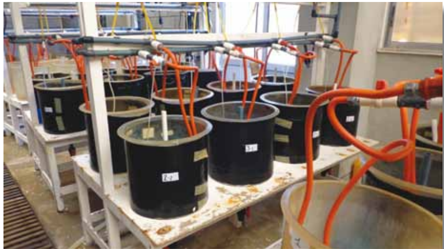
Figura 2: Set experimental utilizado para el estudio de las dietas mono-específicas de microalgas.
